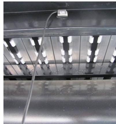
Bild 9: Sensor unter dem Fahrzeugboden
