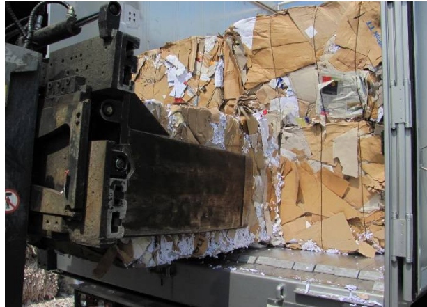
Bild 8: „Nachsetzen“ mit Klammerstapler bei der Beladung und Betätigung des Schubbodens
